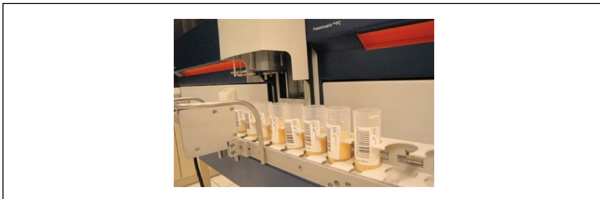
FIGURA 4 - Equipamento eletrônico Fossomatic para contagem de células somáticas através da citometria de fluxo.
