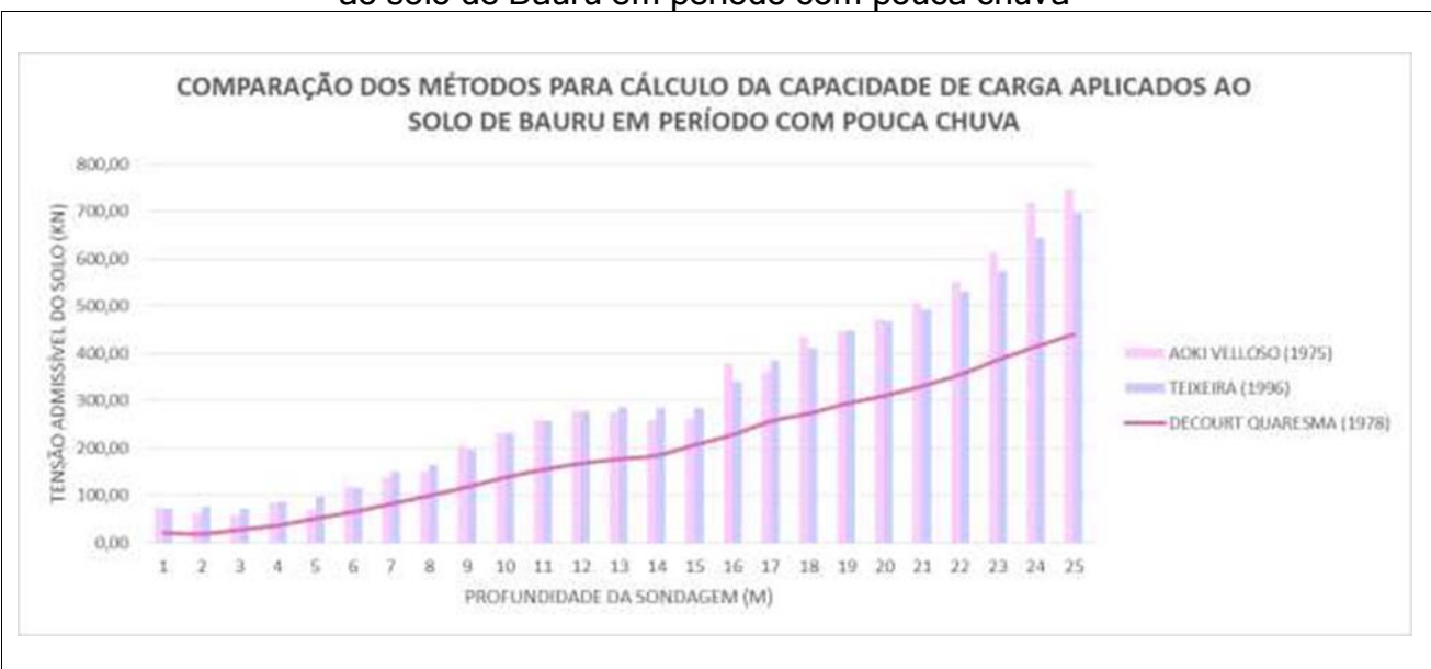
Gráfico 02. Comparação de métodos para capacidade de carga em estacas aplicadas ao solo de Bauru em período com pouca chuva
