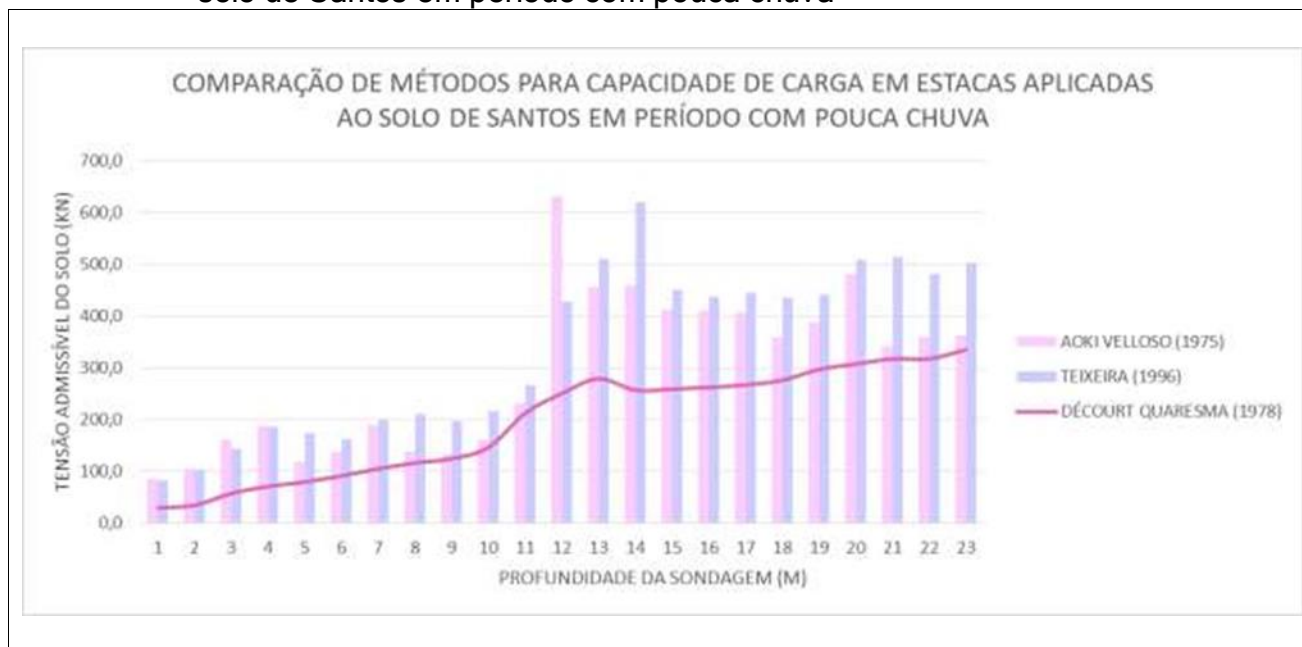
Gráfico 01. Comparação de métodos para capacidade de carga em estacas aplicadas ao solo de Santos em período com pouca chuva
