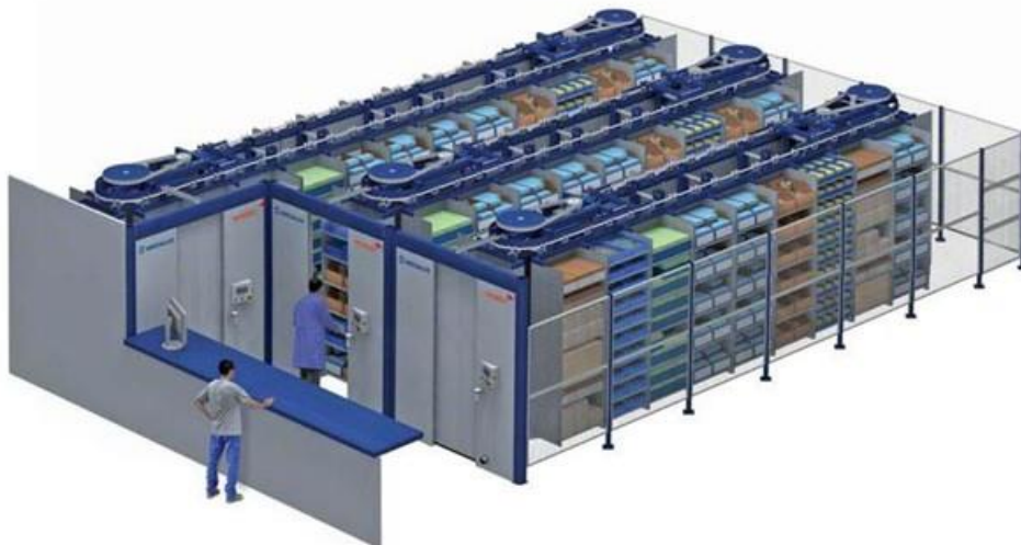
Figura 10. Sistema de armazenagem em carrossel.
