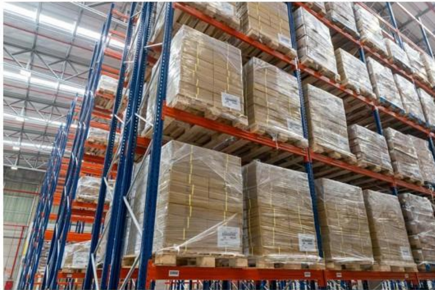
Figura 08. Sistema de armazenagem em porta paletes.
