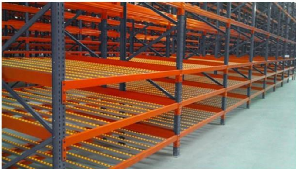
Figura 07. Sistema de armazenagem em Flow Rack
