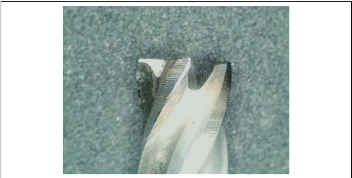
**Figura 9** - Fresas aplicadas ao fresamento com fluido de corte.
