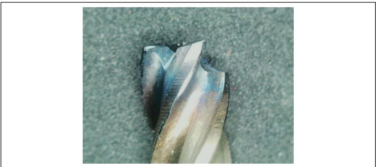
A aplicação do jato de ar comprimido pode remover boa parte dos cavacos na região do canal fresado, e, com isso, permitiu que o ar comprimido atingisse as arestas de corte e a peça, ambas em elevadas temperaturas. Com isso, a fresa indicada na Figura 8, demonstra menores níveis de danos térmicos se comparada com o corte à seco.
