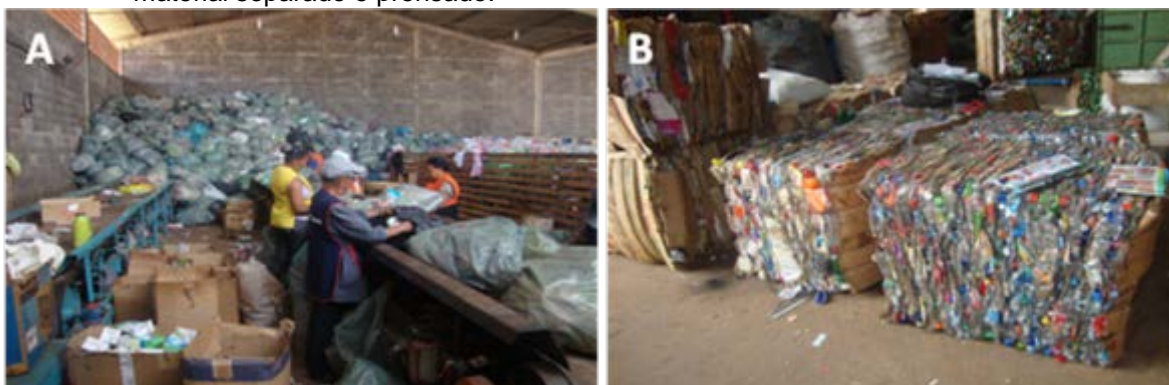
Figura 6. Central de triagem da OSCIP. A. Separação do lixo pelos colaboradores em mesas. B. material separado e prensado.
