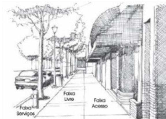
Figura 6. Calçada urbana conforme NBR 9050. Fonte: Manual do Desenho Universal.
